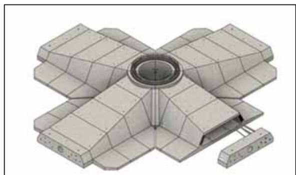
Afbeelding 2.6 - The RUTE BXG Box Girder Precast Foundation (www.rutefoundations.com, sd)
