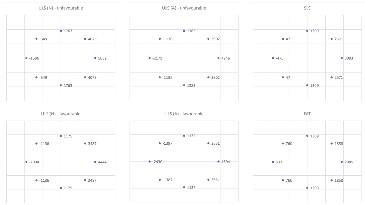
Afbeelding 4.2 - Visualisatie reactiekrachten Ter plaatse van. poeren (verticaal)
